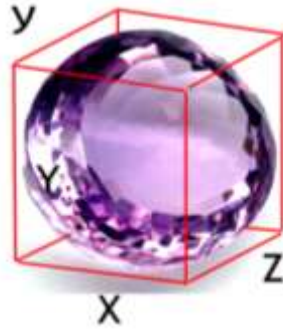
Рис. 1. Брутто розміри огранованого коштовного каменя (аметиста) – паралелепіпед, описаний навколо огранованого каменя, має лінійні розміри {X;Y;Z}, які відповідають його найбільшим лінійним розмірам, тобто, об'єм описаного паралелепіпеда є найменшим, куди можна вставити огранований камінь
